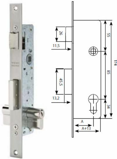
Cerradura de 1 punto para perfil metálico con palanca deslizante reforzada.
