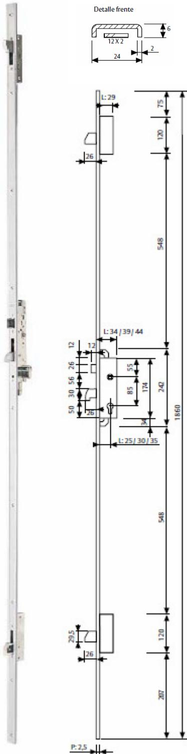
Cerradura de 3 puntos para perfil metálico con frente plano..
